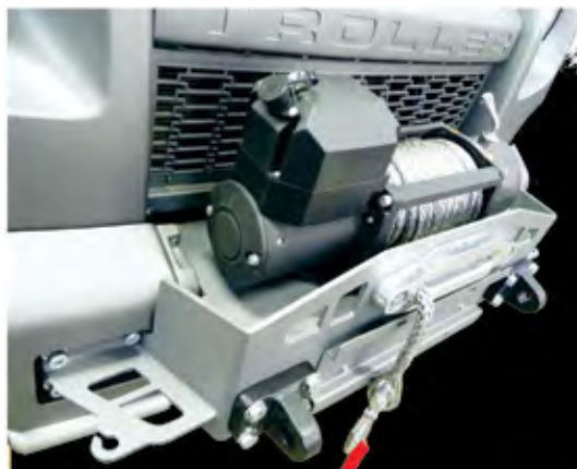
Base de guincho usado sobre o para-choque original
