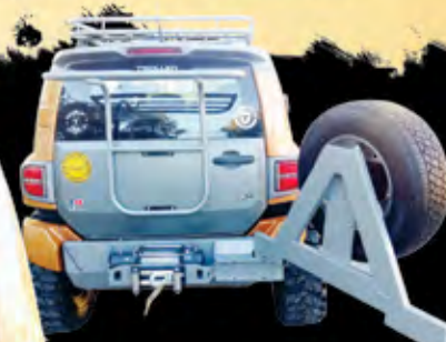
Suporte para estepe de ate 37" com regulagem de altura
