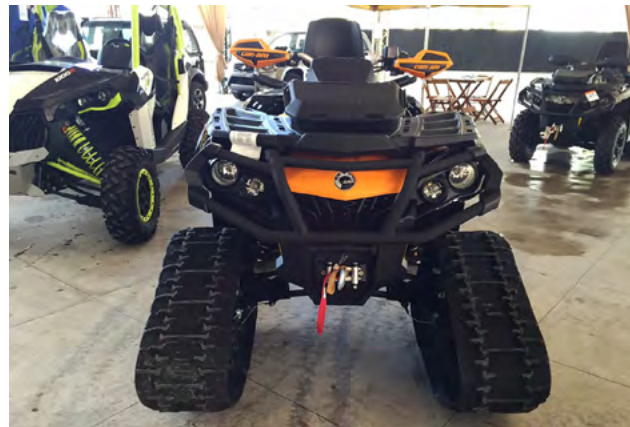
Kit de Esteira Apache que substitui as rodas dos quadris
